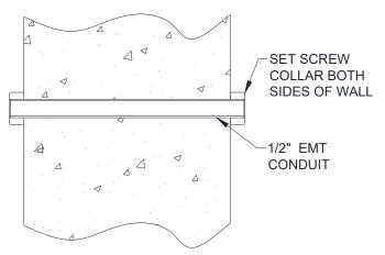
Figure 9.4. Through Wall Conduit
